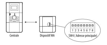
La configuration des dispositifs doit se faire hors alimentation. Vérifier que tous les interrupteurs de SW4 sont sur ON. Basculer l'interrupteur POWER sur ON, la LED s'allume un bref instant.
