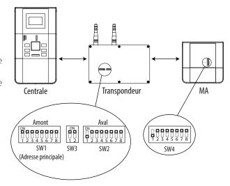
La configuration des dispositifs doit se faire hors alimentation. Vérifier que SW4 du MA est configuré comme l'adresse côté aval du transpondeur
